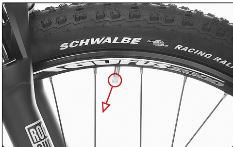
Ventil zeigt nicht zum Laufradmittelpunkt
